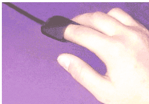
Figura 1: Esempio di sensore Fotopletismo . Il sensore viene applicato al dito di un soggetto.
